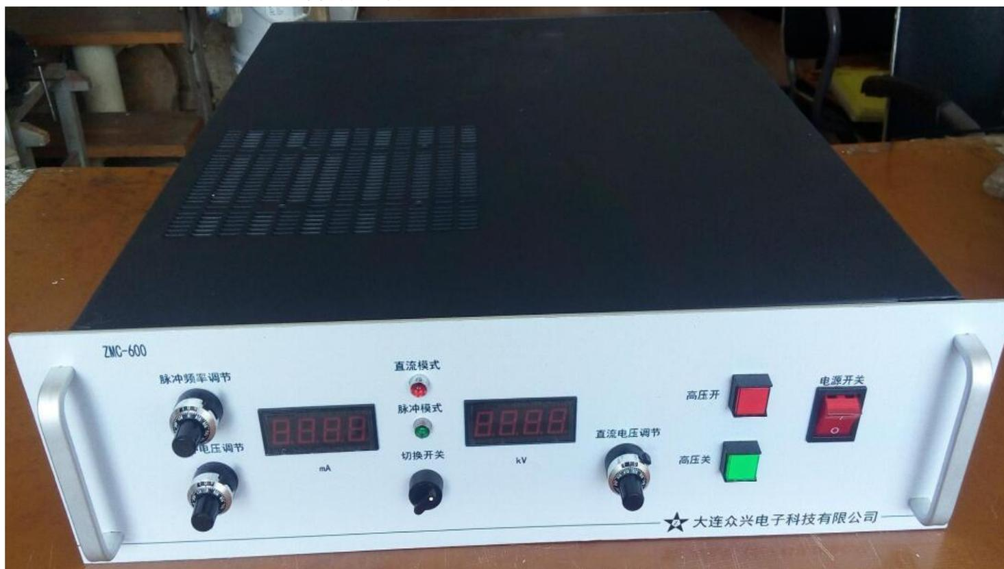
这是典型应用于空气净化的高压电源，有两种输出功能，1是直流高压模式，2是脉冲高压模式，可以切换使用，对用户使用极为方便，就不需要使用两台电源来反复切换拔插，节约了人工和设备成本，而且体积与传统工频电源相比要小很多，效率要高很多，这也是高频开关电源的优势。
